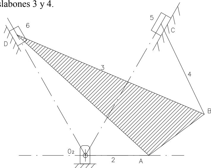
2. Determine, para la posición mostrada, la aceleración angular de los eslabones 3, 4 y la aceleración de los puntos B y C , si  $\omega_2 = 30 \text{ rad/seg}$ .
