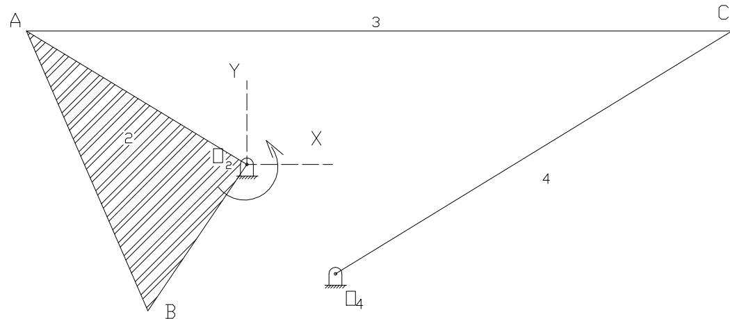
3. Determine, para la posición mostrada, las velocidades angulares de los eslabones 3, 4 y la velocidad de los puntos B y C, si  $\omega_2 = 20$  rad/seg.
