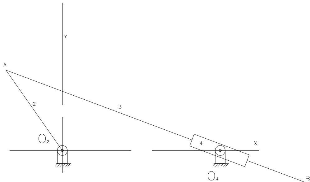
2. Para el mecanismo de la figura determine la velocidad angular del eslabón 3, y la velocidad de los puntos A, B y C si la velocidad angular del eslabón 2, es 30 rad/seg.
