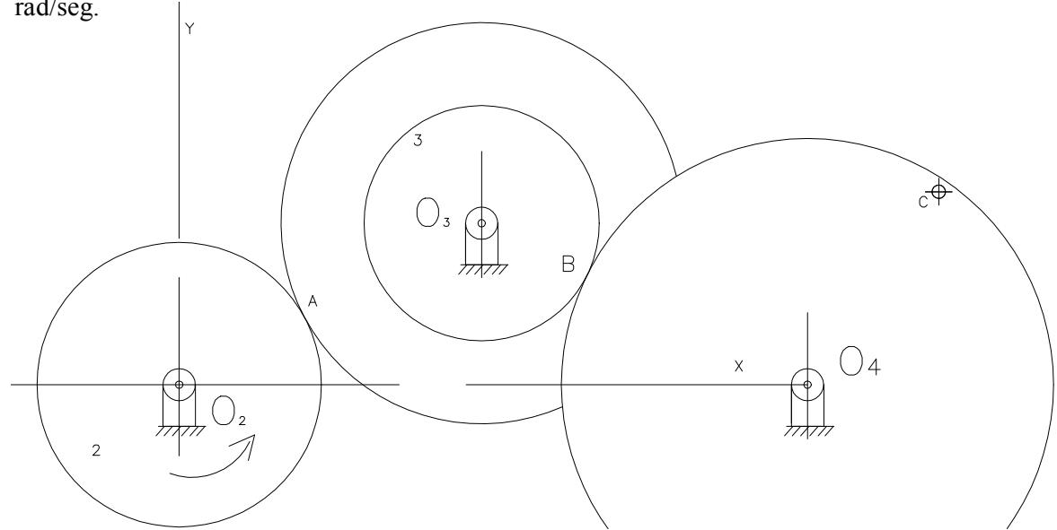
2. Determine la aceleración angular de los eslabones 3 , 4 y la aceleración del punto B, si la velocidad angular del eslabón 2 es de 30 rad/seg.
