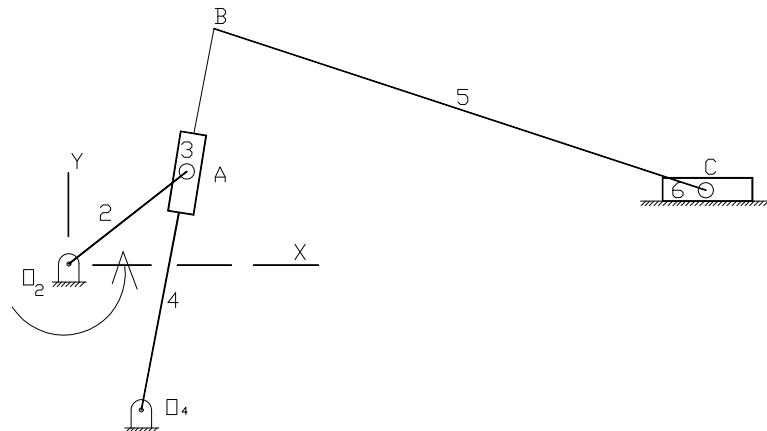
2. Dibuje el polígono de aceleraciones, calcule las aceleraciones de los puntos A, B, y C y las aceleraciones angulares de los eslabones 3 y 4, si  $\omega_2 = 5$  rad/seg.
