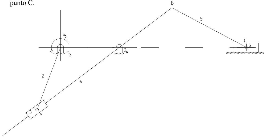
2. Para el mecanismo de la figura, en el problema anterior, determine la velocidad angular del eslabón 3, 4, 5 y la velocidad de los puntos A, B y C si la velocidad angular del eslabón 2, es 30 rad/seg.
