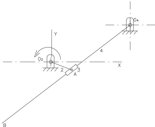
2. Determine: a) la velocidad angular de los eslabones 3 y 4, b) la velocidad del punto C, c) la aceleración angular de los eslabones 3 y 4, d) la aceleración del punto C, si  $\omega_2 = 50$  rad/seg.
